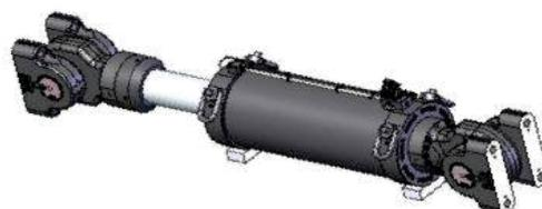
**Sistema de Ensayo para estructuras con 02 Actuadores dinámicos de 1 MN de igual área, 01 Actuador de 2.5 MN y 01 Actuador de 5 MN**
